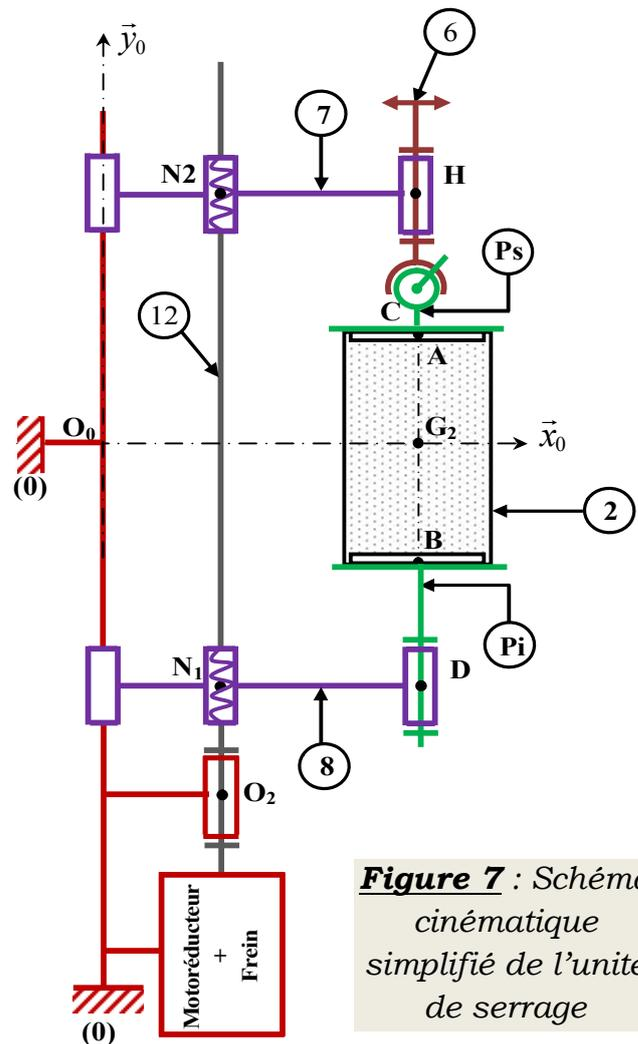
**Figure 7 :** Schéma cinématique simplifié de l'unité de serrage
