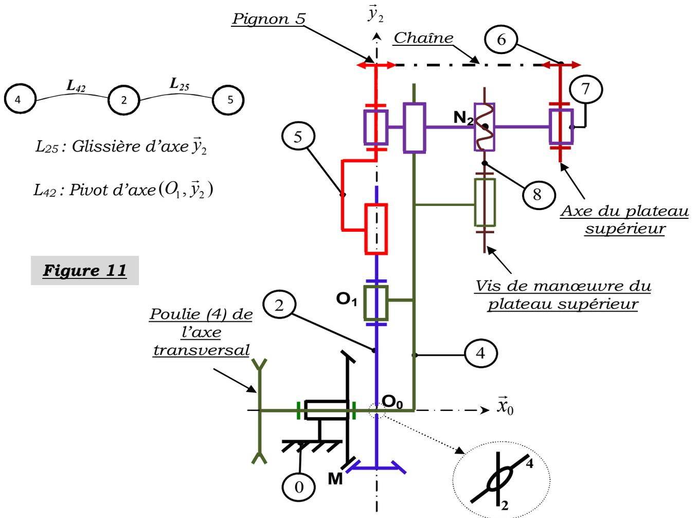
Le système de transmission est constitué d'une chaîne en série composée du moyeu (4), de l'arbre (2) et du solide intermédiaire (5).
