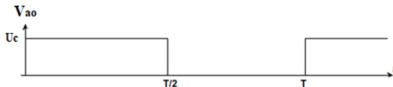
**Figure 10-** Tension simple produite par l'onduleur
