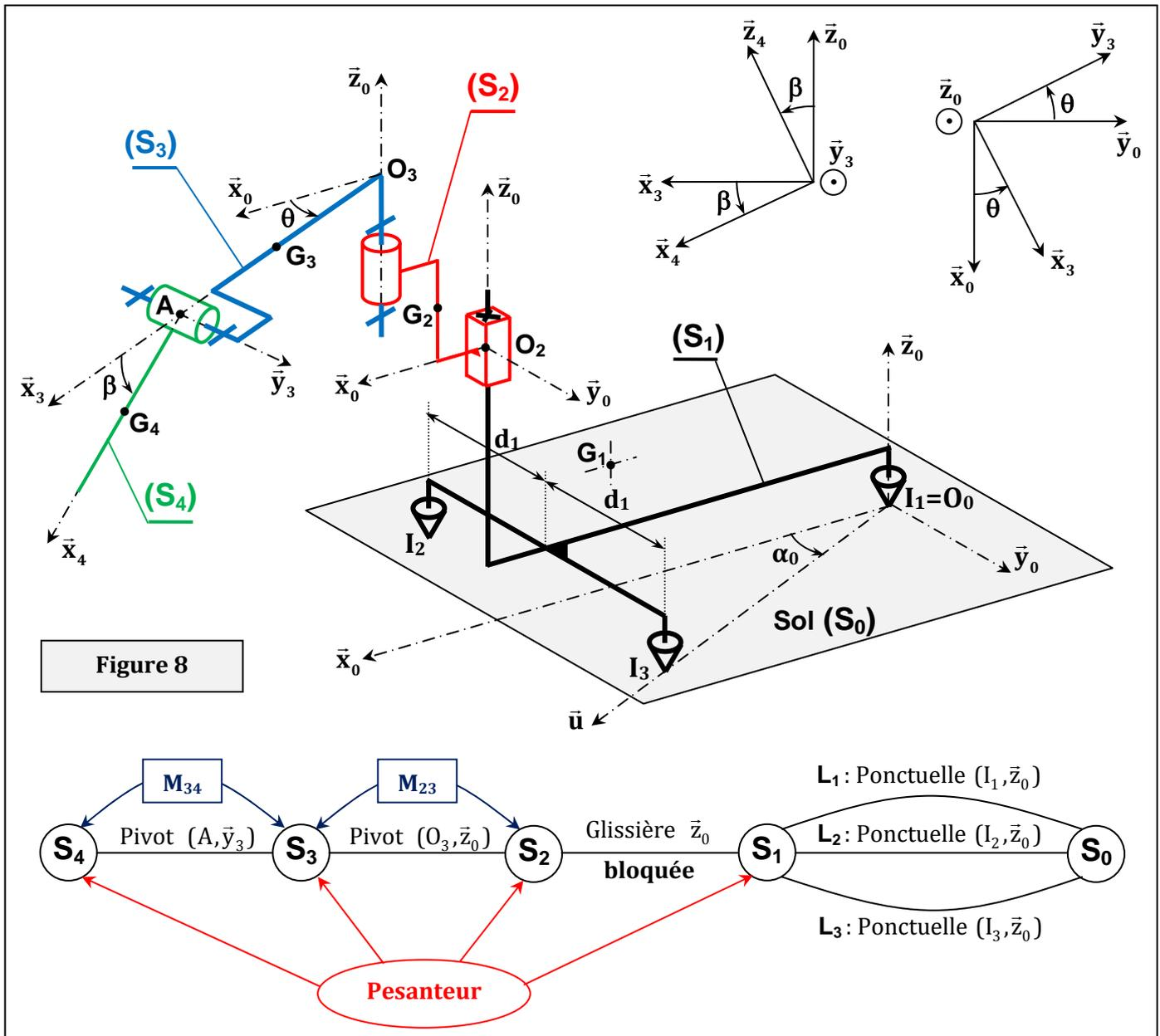
On s'intéresse par la suite à l'étude de l'exigence d'identité « 1.2.2 » (**Diagrammes des exigences page 2**) visant à éviter le basculement de ROBY qui peut être dû aux effets d'inertie pendant le déploiement du manipulateur Kuka.
