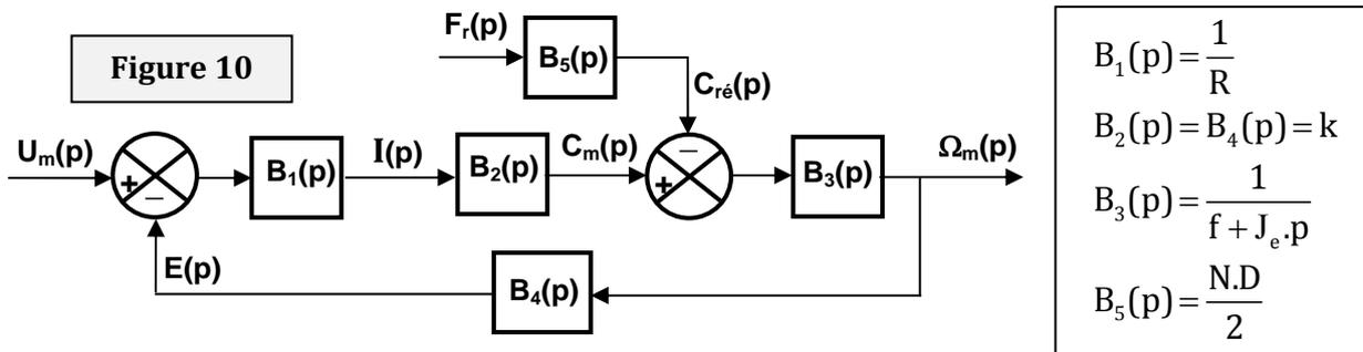
$R$  : résistance de l'induit ;  $k$  : constante de couplage ;  $f$  : coefficient de frottement visqueux équivalent ramené au moteur ;  $J_e$  : moment d'inertie équivalent ramené au moteur.
