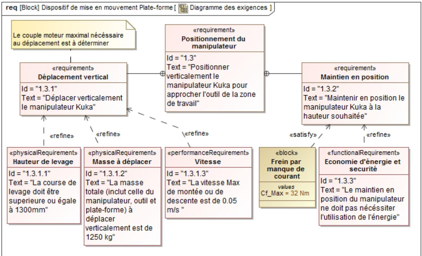
La figure 2b du document Annexe 2 décrit les constituants du dispositif de mise en mouvement vertical de la plate-forme.
