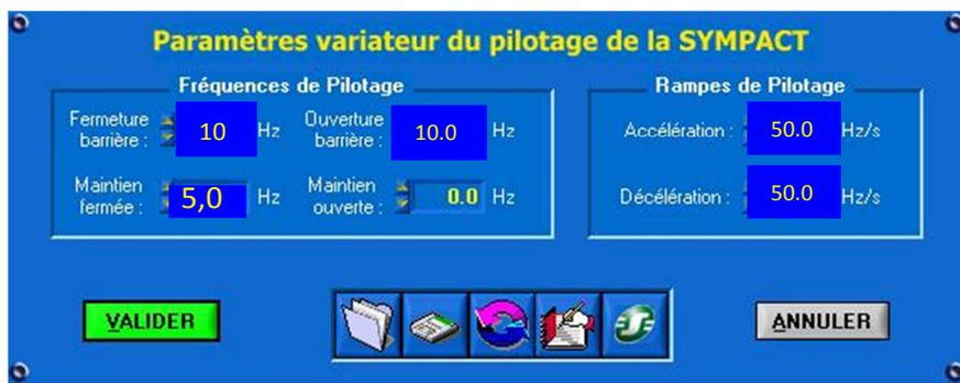
Sous les hypothèses de linéarité et de suivi parfait de cette loi de pilotage imposée au niveau du variateur de vitesse, on obtient une loi en trapèze de vitesse symétrique au niveau de la lisse définie partiellement ci-dessous :
