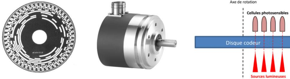
Le capteur absolu possède un disque à  $n$  pistes, chacune lue indépendamment. Le principe consiste à récupérer l'information binaire envoyée par les  $n$  capteurs associés aux  $n$  pistes et à recréer un nombre entre 0 et  $2^n - 1$ , correspondant à la position du disque parmi les  $2^n$  possibilités de mesure.
