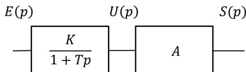
Pour mesurer A, on impose une valeur de U et on mesure S, on obtient A par division. On peut imposer un échelon sur E, et connaissant K, déduire de la valeur finale de S la valeur de KA, donc de A. Cette seconde méthode induit des incertitudes dans A à cause de celles dans K...
