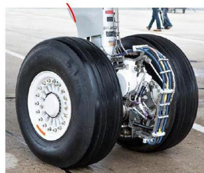
Le taxiage électrique (EGTS) consiste à lacer des actionneurs au niveau des roues pour permettre à l'avion de se déplacer seul pendant le push back et le roulage, sans l'aide de ses moteurs ni des véhicules de traction des aéroports. Ces actionneurs sont entraînés grâce à l'énergie électrique fournie par le système auxiliaire de puissance (APU : Auxiliary Power Unit). Le pilote peut lui-même gérer les manœuvres au sol.
